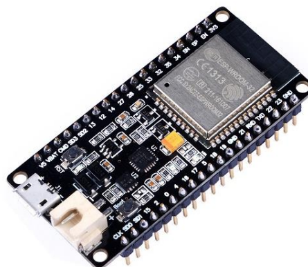
Figura 3.3 - ESP32 com dimensões 28mm x 58mm
