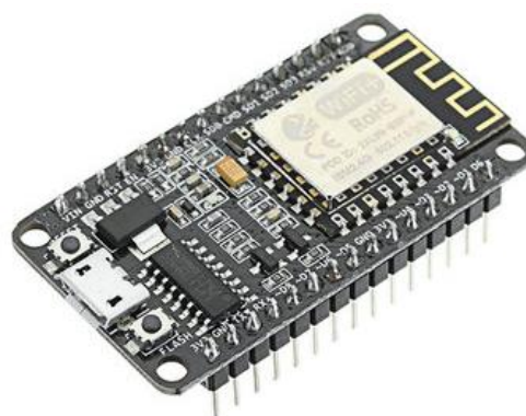
Figura 3.2 - ESP8266 com dimensões de 25mm x 48mm
